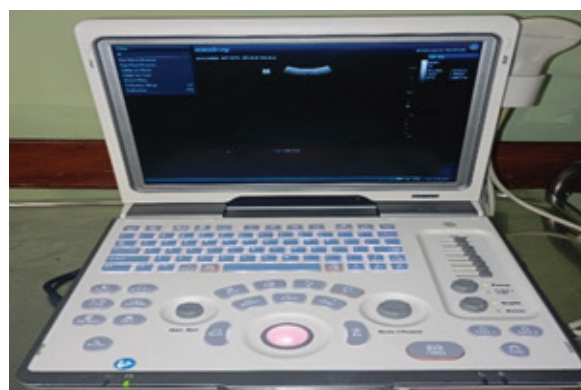
Figure 1 : Échographie Mindray DP 50, 2016, Sonde convexe 35C50EA de 3,5 MHz.
